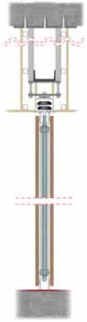
NPU çelik taşıyıcıya bağlantı
