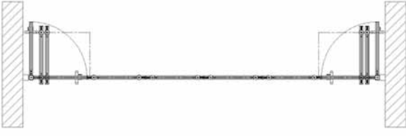
İki tarafa duvar önü depolama
